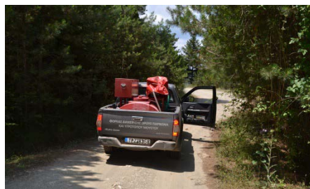
Όχημα φύλαξης του Φ.Δ. με θυτίλο πυρόσβεσης, χωρητικότητας 500 λίτρων νερού και μάνικες κατάσβεσης.
