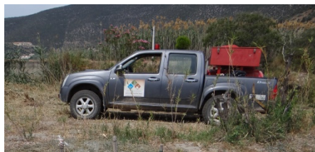
Όχημα φύλαξης του Φορέα Διαχείρισης με θυτίο πυρόσβεσης, χωρητικότητας 500 λίτρων νερού και μάνικες κατάσβεσης.
