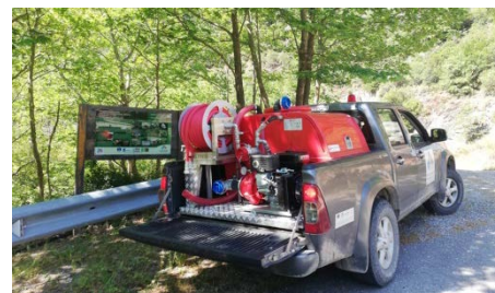
Σύγχρονα πυροσβεστικά βυτία χωρητικότητας 500 λίτρων νερού με μάνικες πυρόσβεσης όπως εγκαταστάθηκαν τον Μάιο του 2020 στα οχήματα αγροτικού τύπου που διαθέτει ο Φορέας Διαχείρισης
