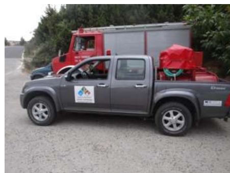
Όχημα φύλαξης του Φ.Δ. με βυτίο πυρόσβεσης, χωρητικότητας 500 λίτρων νερού και μάνικες κατάσβεσης.
